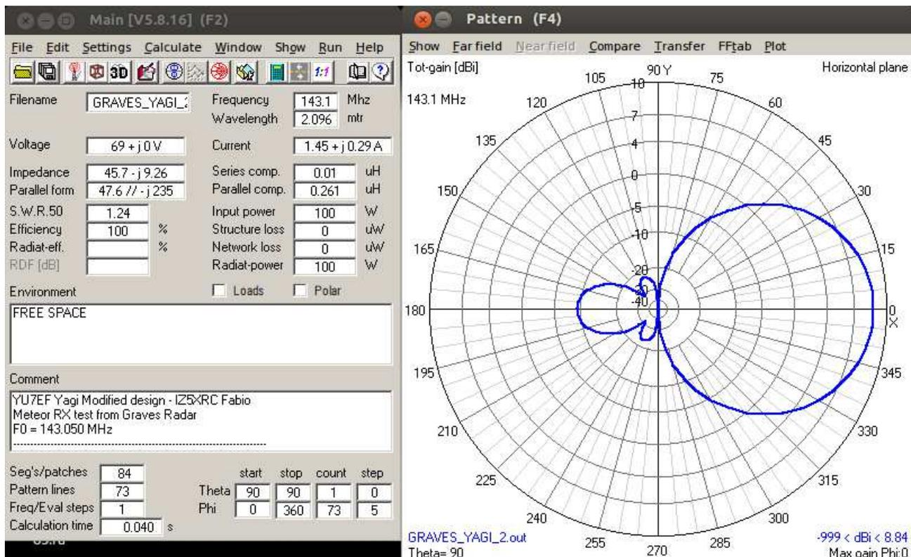
Questa è la simulazione per 143.1MHz, invece quella per la frequenza per cui ho scalato il design (144MHz) è:
