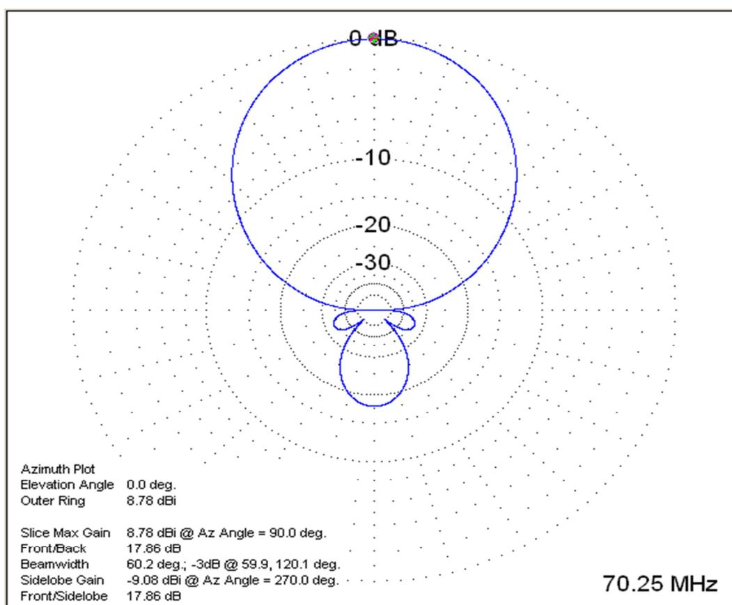
Il diagramma d'irradiazione è pulito e mi è sembrato un buon compromesso anche il rapporto F/B. Come si vede dalla simulazione originale la frequenza di progetto iniziale è 70.25MHz, per il mio progetto ho invece usato la frequenza di 144.00MHz poiché avrei voluto usare l'antenna anche per qualche contest in portatile.
