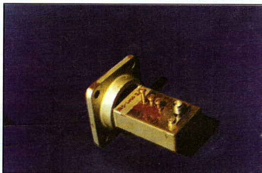
Foto 2 - Transizione guida-cavo realizzata con guida WR-90 e flangia standard senza choke. Sono visibili le tre viti dello screw tuner di cui la prima, verso il lanciatore, è la più introdotta per cancellare la reattanza del carico a 10451 MHz.
