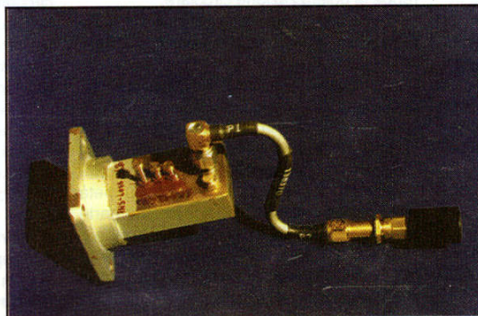
Foto 6 - Il carico da 50\ \Omega con ROS=1,25 è stato collegato alla transizione mediante un tratto di cavo UT-141 per verificare la trasformazione di impedenza e la variazione di ROS provocata dalla reattanza dei connettori, in particolare a gomito.
