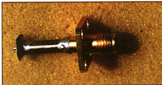
Foto 5 - Corto realizzato su un tratto di cavo UT-141 connesso a femmina SMA, per verificare la potenza W_r dell'onda riflessa.
