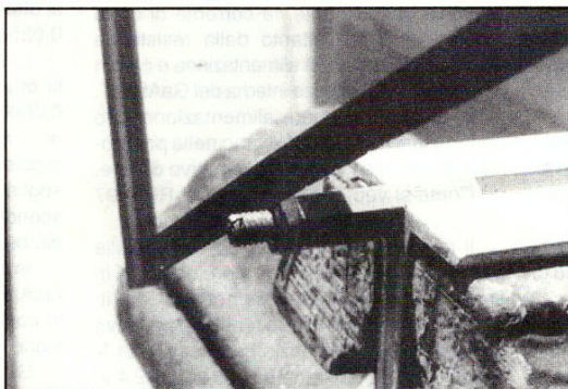
Foto 4 - Attrezzo per il taglio dei bulloni di taratura di cavità e filtri che consente di non schiacciare i filetti del bullone nelle ganasce della morsa.
