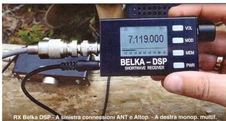
RX Belka DSP - A sinistra connessioni ANT e Altop. - A destra monop. multif.
