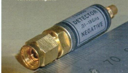
Foto 2 - Diodo LBSD HP33330B con uscita negativa
