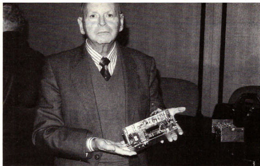
TR8BL - Luciano Bertucci mostra l'amplificatore doppio ridondante da 20 W a 145 MHz del satellite ARSENE
