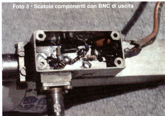
Foto 3 - Scatola componenti con BNC di uscita
