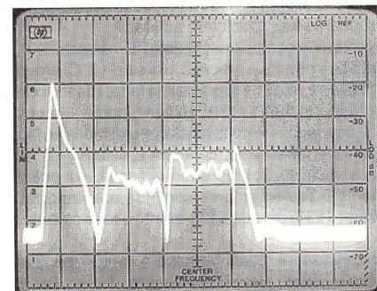
Fig. 21 - Risposta in frequenza. Il livello del segnale di ingresso (tracking generator) è -40 dBm. Il livello del segnale di uscita a 145 MHz è -20 dBm G = -20 - (-40) = 20 dB. Tutti i segnali fino a 1300 MHz sono al disotto del livello del segnale di ingresso, con un massimo di -10 dB a 432 MHz. Tale selettività è data dal diplexer. Non si notano autooscillazioni sul preamplificatore, chiuso su 50 \Omega resistivi. Scan width = 0 ÷ 1300 MHz; 185 MHz/Div Vert./Div. = 10 dB; Filter = 10 kHz
