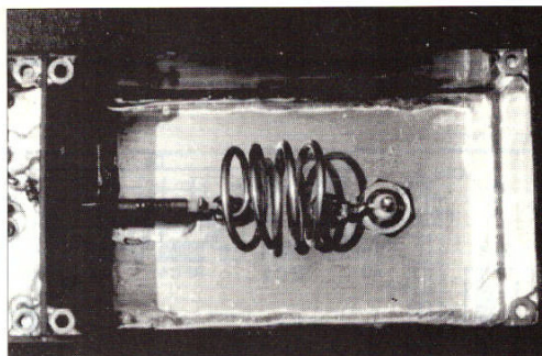
Foto 2 • Filtro passa basso a pi-greco, di ingresso. L'induttore è saldato direttamente su C2 e C3. I due condensatori C1 e C4 da 4,7 pF sono ceramichi chip. L'uscita del filtro è collegata allo scomparto dell'amplificatore mediante un cavetto UT-141.
